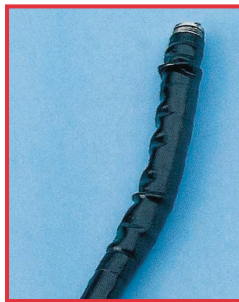
Набухание шланга вследствие применения неподходящего средства для ухода
