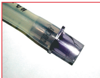
Растрескивание вследствие напряжения
