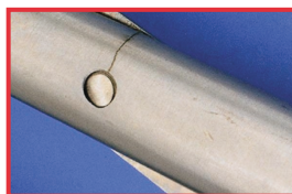
Микротрещина на участке резьбы ножниц
