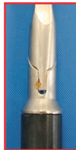
Шарнирный участок инструмента для малоинвазивной хирургии
