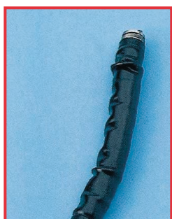
Набухание дистального конца волоконного эндоскопа
