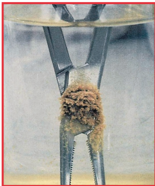
Образование ржавчины на инструменте, много часов находящемся в физиологическом растворе поваренной соли
