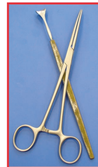
Контактная коррозия нерж. стали с латунью
