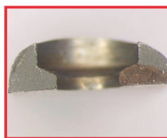
Излом в отверстии для головки винта
