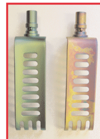
Левый клапан: новый; однородный зеленый цвет; правый клапан: подвергнувшийся машинной очистке: с цветными разводами
