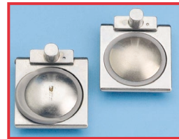
Неплотный клапанный вентиль троакара вследствие набухания уплотнения при контакте с маслом
