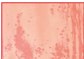
Оптическое изменение цветного анодированного алюминия даже при лёгкой щелочности
