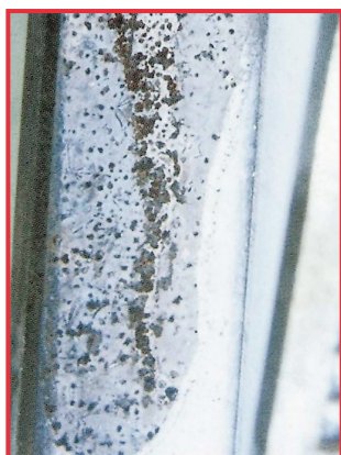
Отложения хлоридсодержащего медикамента на инструменте
