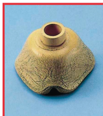
Трещины старения на дыхательной маске
