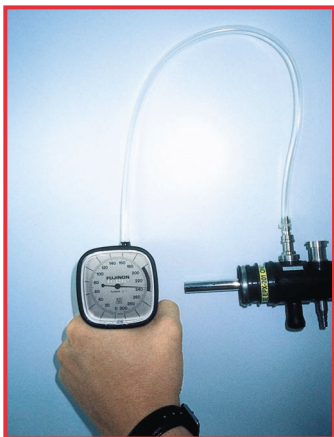
Ручная проверка герметичности гибкого эндоскопа
