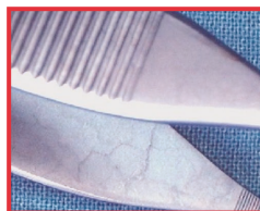
Окраска инструментов с цветными краями пятен
