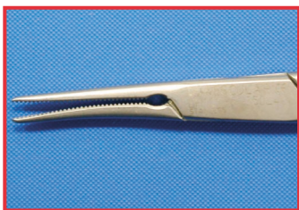
Деформация в результате неправильного обращения
