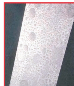
Поверхность инструмента с цветными пятнами в форме капель
