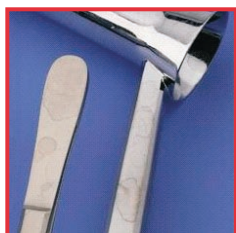
Появление пятен из-за высокого содержания соли в воде для ополаскивания
