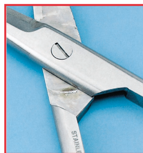
Коррозионная эрозия из-за недостаточной смазки
