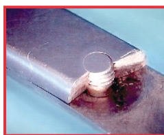
Сломанные на резьбе ножницы
