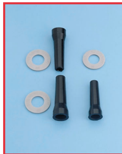
Набухшие уплотнения вследствие небрежного нанесения масла для смазки инструмента
